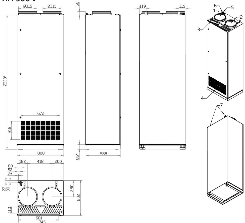
\*Das Maß kann, ohne montiertes Panel und Maschinenfüße ganz eingeschraubt, um bis zu 50 mm reduziert werden.
