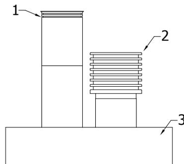
Als Abschluss der Montage von Fortluft und Einlass durch das Dach werden Dachhauben montiert. Die Montage ist von der Dachkonstruktion abhängig (3). Die Zeichnung gibt an, welche Dachhaube für Fortluft (1) und Einlass (2) ist.
