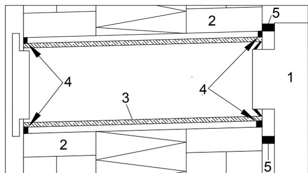
Das Verfugen (hier dargestellt für ein Modell mit Wandkanälen) an der inneren und der äußeren Kante (4) der Kanäle (3) ist wichtig, um Zugluft zwischen Gerät (1) und Wand/Dach (2) sowie Kanälen (3) und Wand/Dach (2) zu verhindern.
