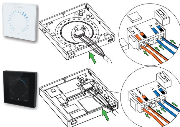
Das Bedienpaneel liegt normaler Weise bei der Lieferung lose bei, ein 6,5 m langes Datenkabel ist vormontiert. Das Bedienpaneel ist in geeigneter Höhe an der Wand zu montieren, generell im gleichen Raum wie das Lüftungsgerät, es ist aber auch eine Montage in angrenzenden Räumen möglich.
