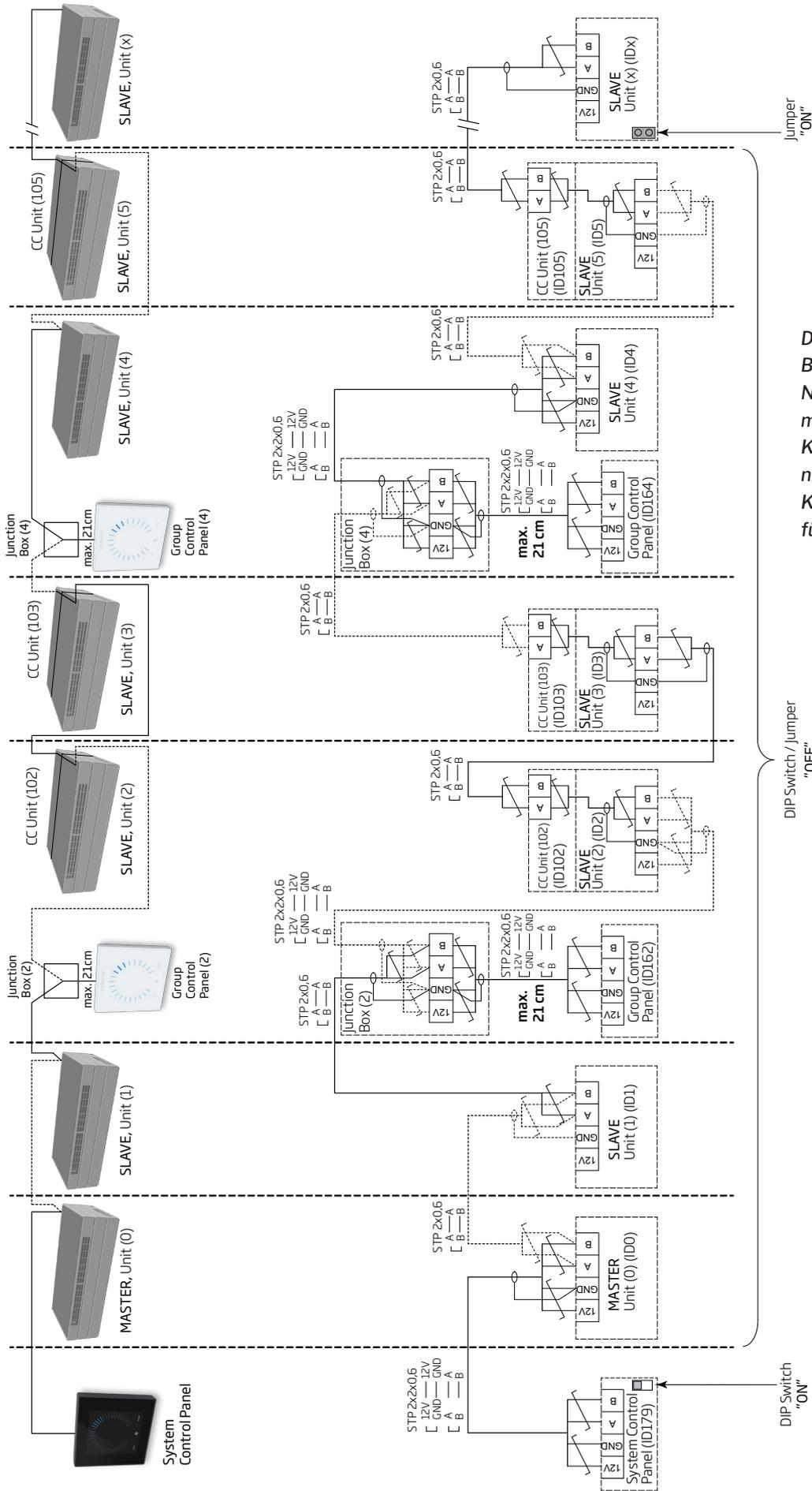
Die Verteilerdose (Junction Box) muss in unmittelbarer Nähe des Bedienpaneels montiert sein. Eine größere Kabellänge als 21 cm ist nicht zulässig und kann zu Kommunikationsfehlern führen.
