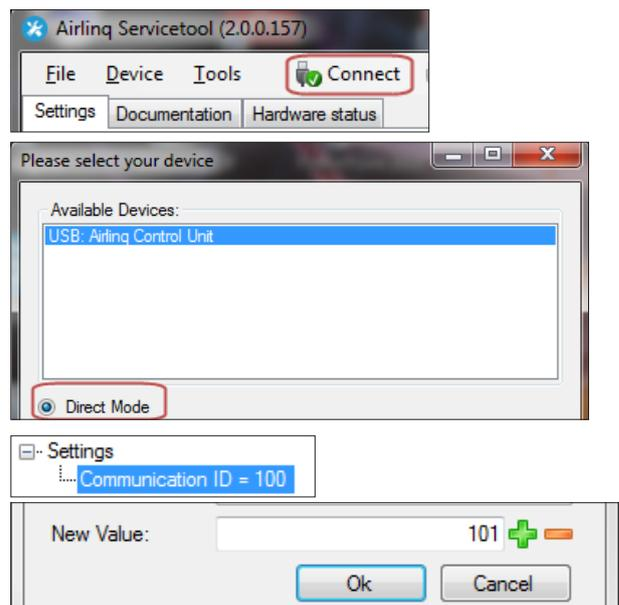
Paarung Lüftungsgerät mit Kühlmodul:
