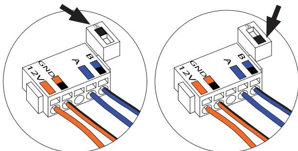
Die Jumper einer Steuerbox sind ab Werk offen („OFF“).
