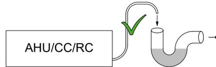
Wir empfehlen, einen Geruchsverschluss am Abwassersystem zu installieren, um schlechten Geruch vom Abwassersystem zu verhindern.
