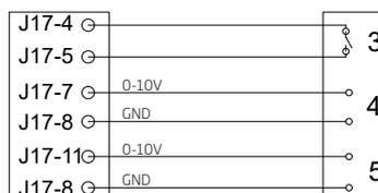
Das A-BMS legt das 13,5 VDC-Ausgangssignal über einen Schließerkontakt (NO) (3) von Klemme J17-4 an Klemme J17-5 (AI#1). Dadurch startet und stoppt das Lüftungsgerät gem. Programmierung des A-BMS.
