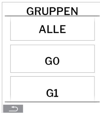
Das Auswahlschirmbild zeigt alle Gruppen (G) oder Geräte (ID), die mit Airlinq BMS verknüpft sind. Bspw. G0 bis G10 sowie ID0 bis ID16, wenn das System aus 11 Gruppen mit insgesamt 17 Geräten besteht.
