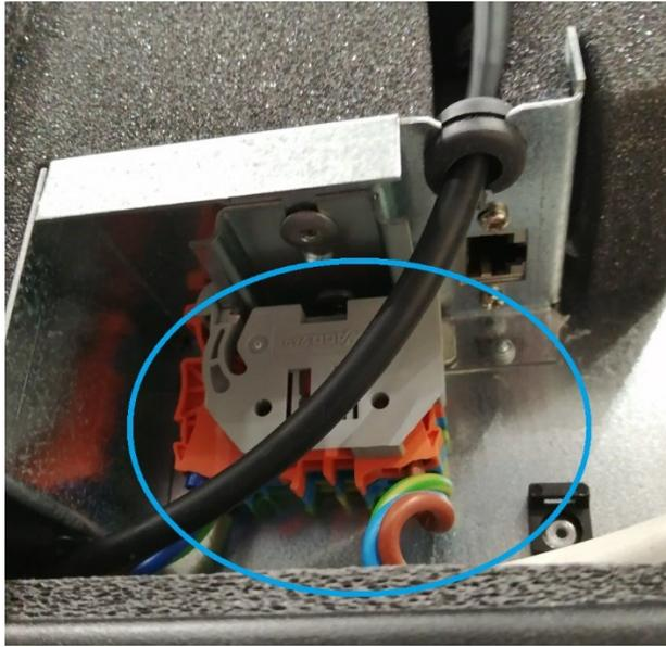
Abbildung 6: Versorgungsklemmleiste
