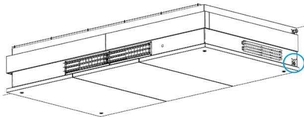
Abbildung 8: Kabeleinführung
