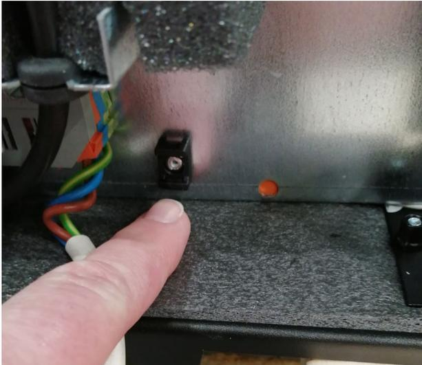
Abbildung 7: Kabelbinderhalterung
