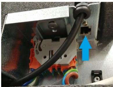
Abbildung 12: Ethernet-Anschluss, RJ45
